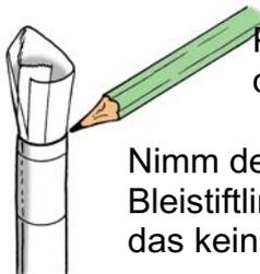
Pass nun diesen Pfeil der Größe des Rohres an. Dazu musst du den Kegel in das Rohr stecken und mit einem Bleistift dem Rohrende entlang fahren.
